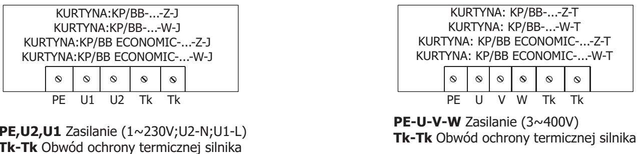
Rys. 4.10 Schemat blokowy podłączenia kurtyn: KP/BB-...[-W;-Z;-J;-T] oraz KP/BB ECONOMIC-...-W-[-J;-T]
